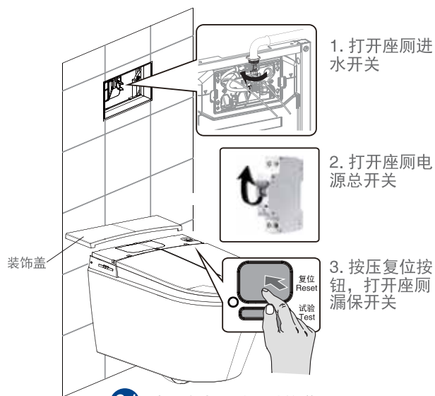
21 接通水电，装上装饰盖
